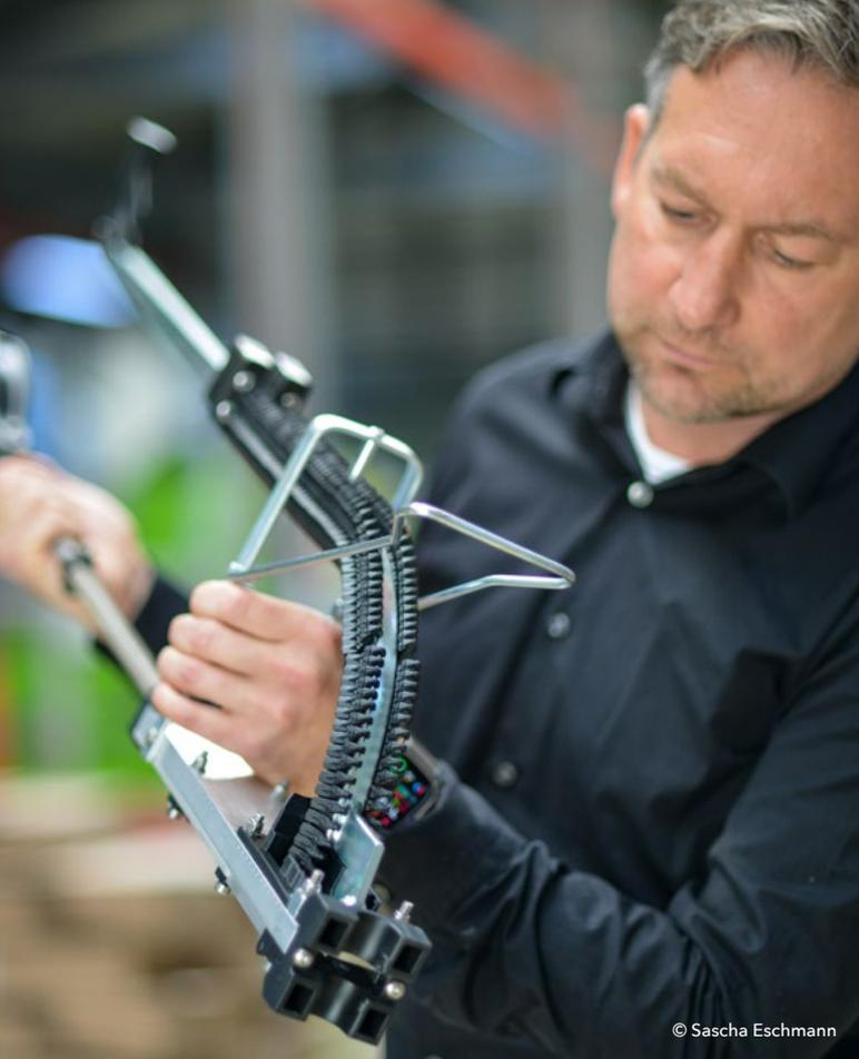
Marco Burk mit dem Tackergerät, welches für die Verlegung von Rohren für Fußbodenheizungen verwendet wird
